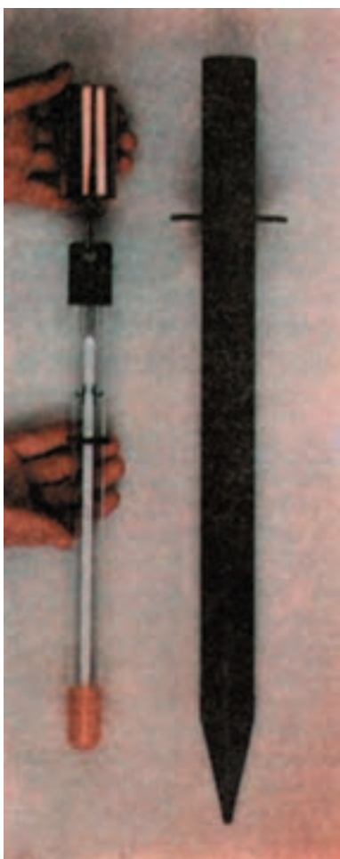
شکل ۲-۲- دماسنج برای اندازه گیری درجه حرارت خاک
