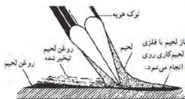
شکل ۷- عملکرد روغن لحیم در پاک کردن اکسیدها از سطح کار
