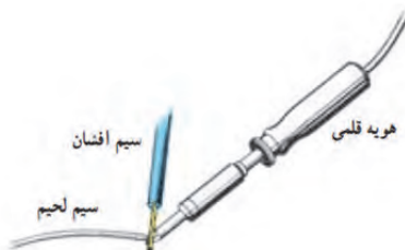
شکل ۱۰_ حوه لحیم کاری سرسیم
