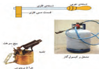
شکل ۸- هویه ساده و دستگاه گرم کننده آن
