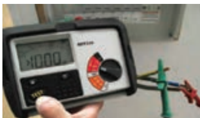
شکل ۵-۶- آزمون بین ارت و دو هادی برق دار
