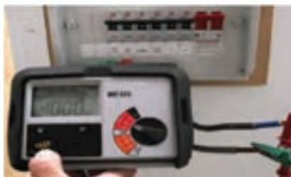
شکل ۵-۵- آزمون بین دو هادی برق دار (فاز و نول)
