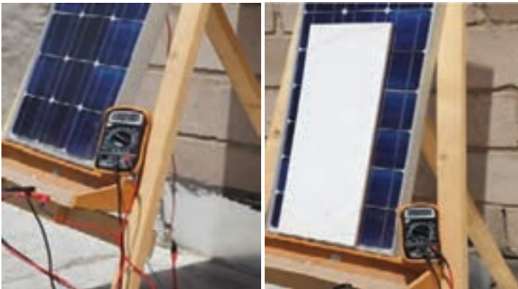
شکل ۱۸- اثر سایه بر ولتاژ بی‌باری خروجی
