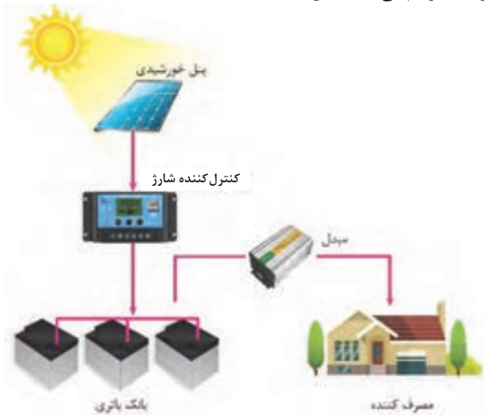
شکل ۲- سامانه مستقل از شبکه برق
