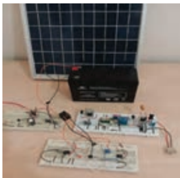
شکل ۱۱۴- سلول‌های خورشیدی مونوکریستال و شکل ۱۱۵- باتری آب‌بندی شده اسیدی در حال شارژ مدار شارژر
