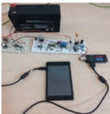
شکل ۱۱۹- تلفن همراه و باتری در حال شارژ از سلول خورشیدی خروجی
