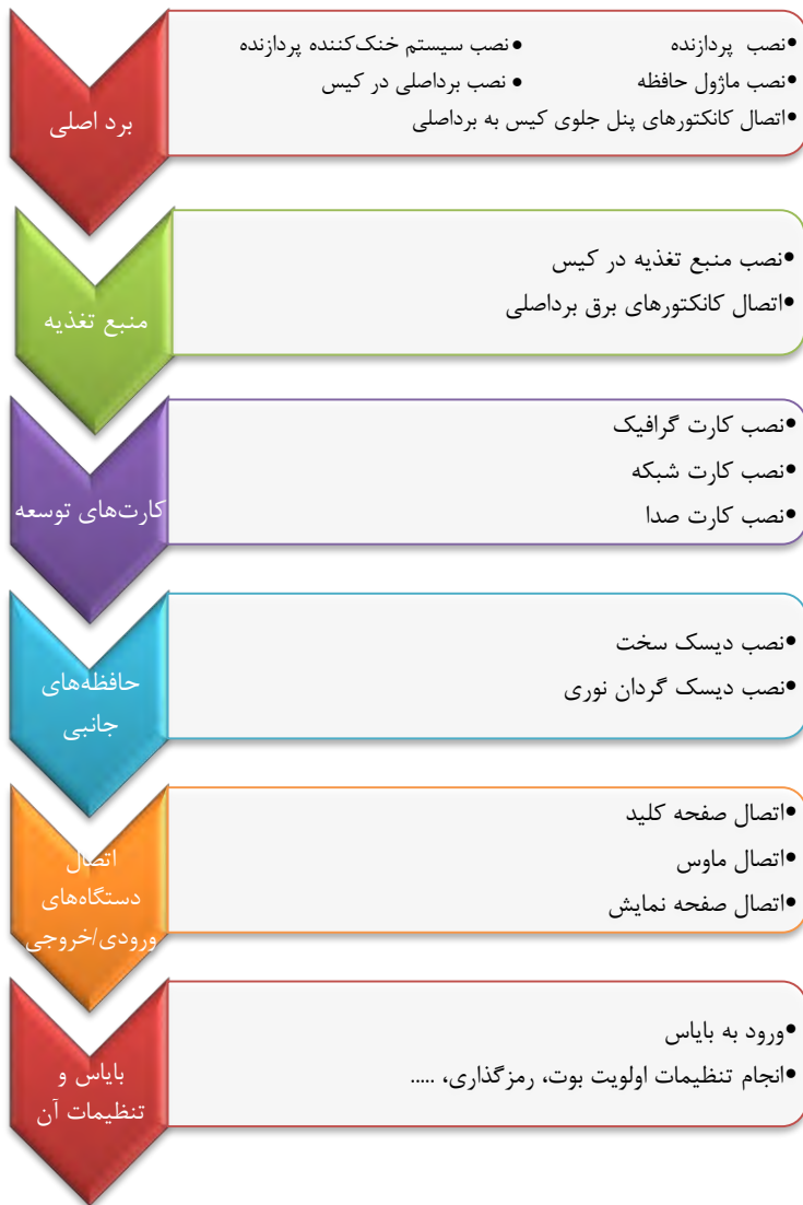
شکل ۴-۱۸ - مراحل مونتاژ یک رایانه
