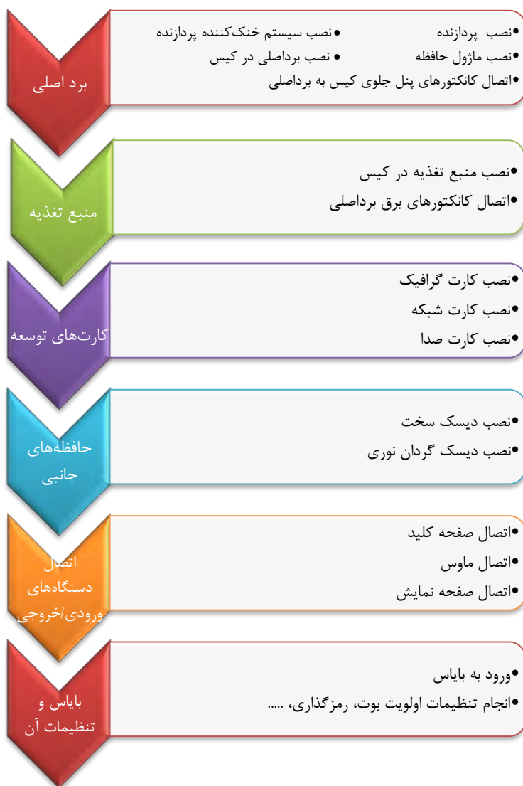
شکل ۴-۱۸ - مراحل مونتاژ یک رایانه
