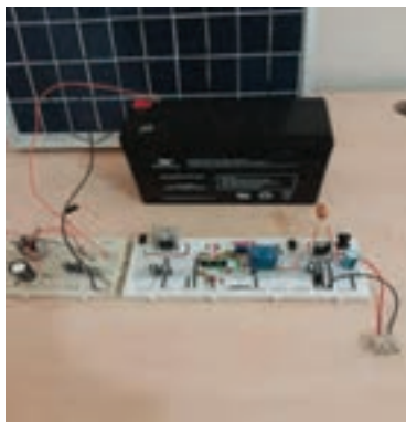
شکل ۱۱۷- نمونه دیگری از شارژر با سلول خورشیدی مدار شارژر
