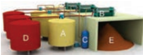
A: مخزن محلول ورودی D: مخزن محلول خروجی B: فیلتر پرس E: کیک خروجی C: مخزن باد دستگاه فیلتر پرس
