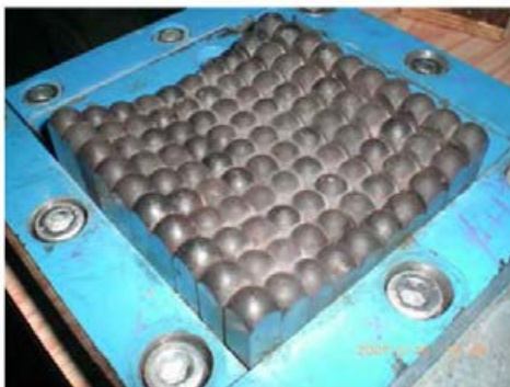
شکل ۲۷- سامانهٔ خمش چندنقطه‌ای (یک سمت سامانه)
