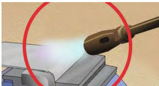
شکل ۱۹- حرارت‌دهی ورق با مشعل برای تسهیل در خمکاری
