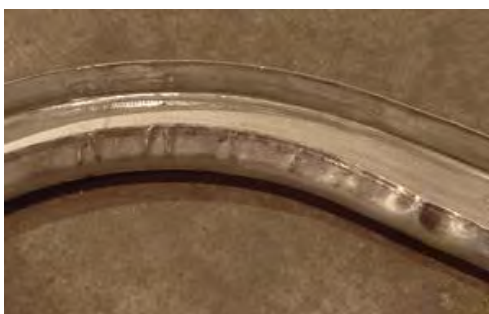
شکل ۲۶- خمیدگی باله‌های پروفیل حین خمکاری
