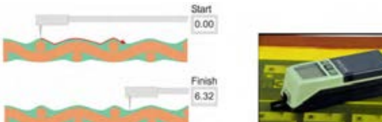
اندازه‌گیری میزان RZ
