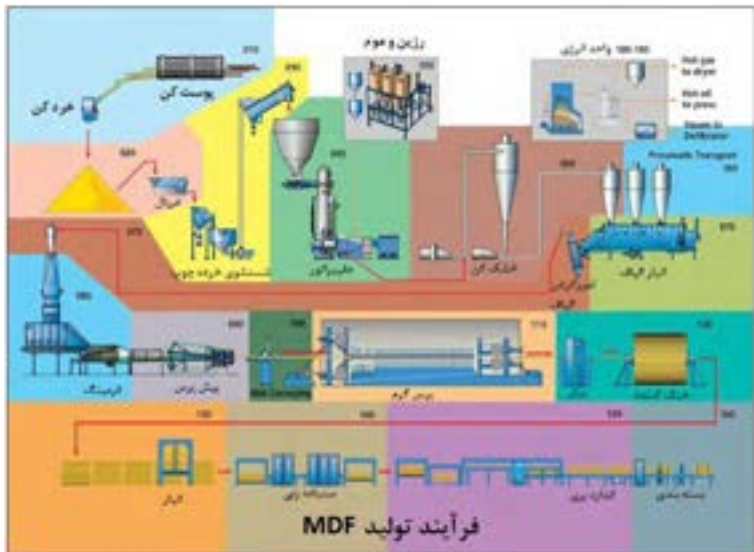
فرآیند تولید ام‌دی اف به صورت شماتیک
