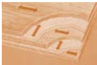
نحوه چیدن لایه‌های تخته لایه روی همدیگر به صورت متقاطع
