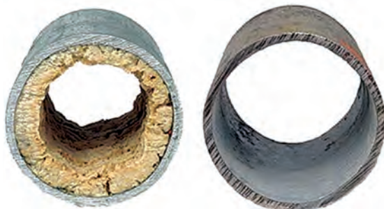
شکل ۱۳- مقایسه دو لوله کار کرده در دو حالت آب تصفیه شده (treated) و تصفیه نشده (untreated)
