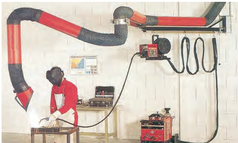
شکل ۳-۱- خروج گاز از محل جوشکاری و تصفیه و هدایت به هوای بیرون
