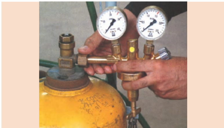
شکل ۳-۵- بستن رگولاتور به کپسول
