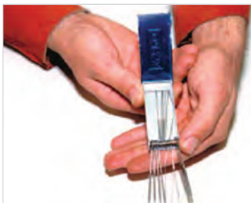
شکل ۳-۷- سری سوزن مخصوص تمیز کردن سر مشعل
