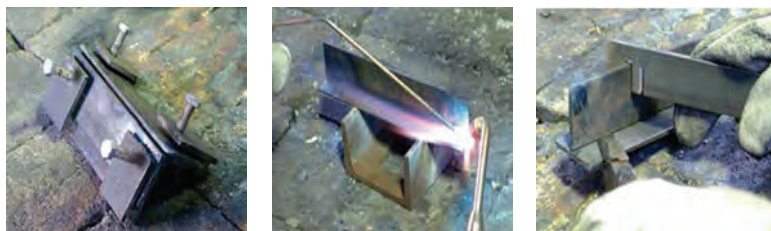
شکل ۳-۲۰- چند نمونه از گیره، نگهدارنده و زیرکار مورد استفاده در جوشکاری
