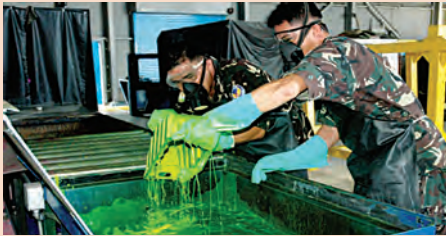
روش غوطه‌وری در مخزن مایع نافذ
