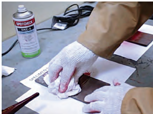
شکل ۱۰- حذف مایع نافذ به کمک دستمال و حلال
