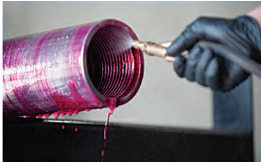
شکل ۹- شست‌وشوی مایع نافذ با آب (سمت راست مایع نافذ فلورسنت سمت چپ مایع نافذ مرئی)
