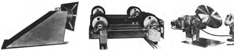
شکل ۳-۱۷- چند نمونه از حالت‌دهنده‌های مورد استفاده در جوشکاری
