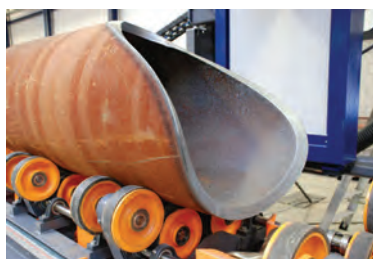
(الف) برش کاری حرارتی - قطعات ضخیم و فرم‌های پیچیده
