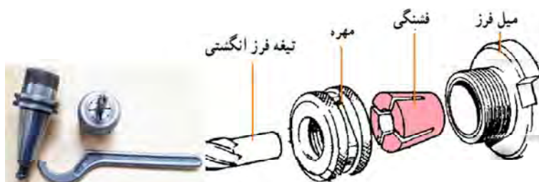
نحوه نصب انگشتی روی فرز گیر
