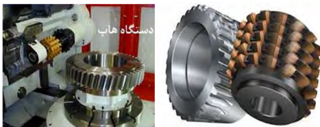
شکل ۴- چرخ‌دنده زنی غلطی (هاب)
