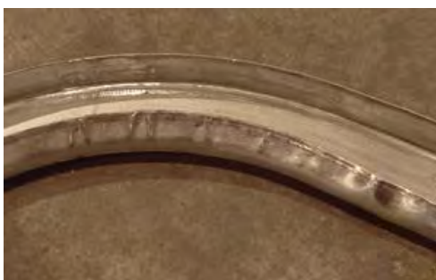
شکل ۲۶- خمیدگی باله‌های پروفیل حین خمکاری
