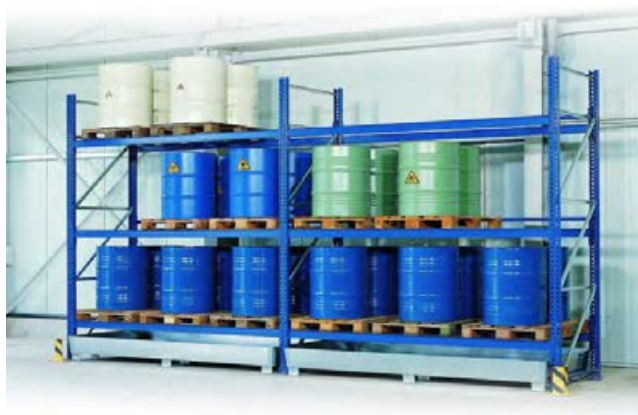
شکل ۲- شیوه صحیح نگهداری بشکه‌های کاربید و مواد خطرناک
