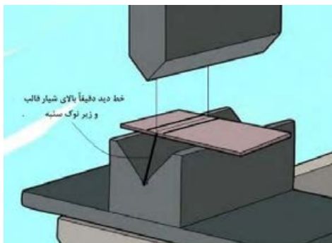
شکل ۱۱- طریقه قرارگیری ورق آلومینیومی در دستگاه
