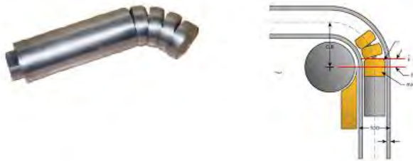
شکل ۲۰- مندرل (سمت چپ) و نحوه به کارگیری آن در لوله حین فرایند خمکاری (سمت راست)
