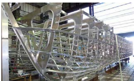
شکل ۲۵- اسکلت آلومینیومی یک نوع شناور متشکل از پروفیل و تقویتی
