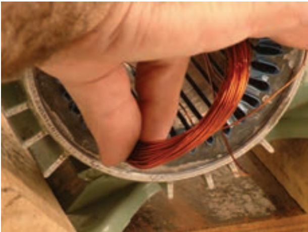
شکل ۲-۱۵- قراردادن بازوی شماره یک در شیار شماره ۱
