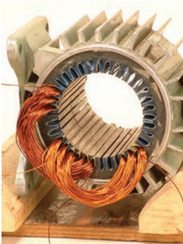
شکل ۲-۲۲- شروع گروه کلاف سوم از شیار شماره ۱۳
