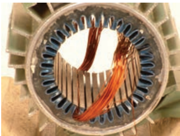
شکل ۲-۷- قرارگرفتن یک بازو در داخل یک شیار
