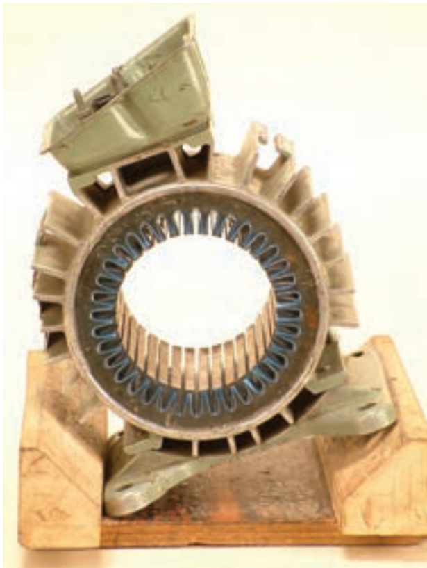
شکل ۲۹-۲-ب - انتخاب شیار شروع سیم بندی
