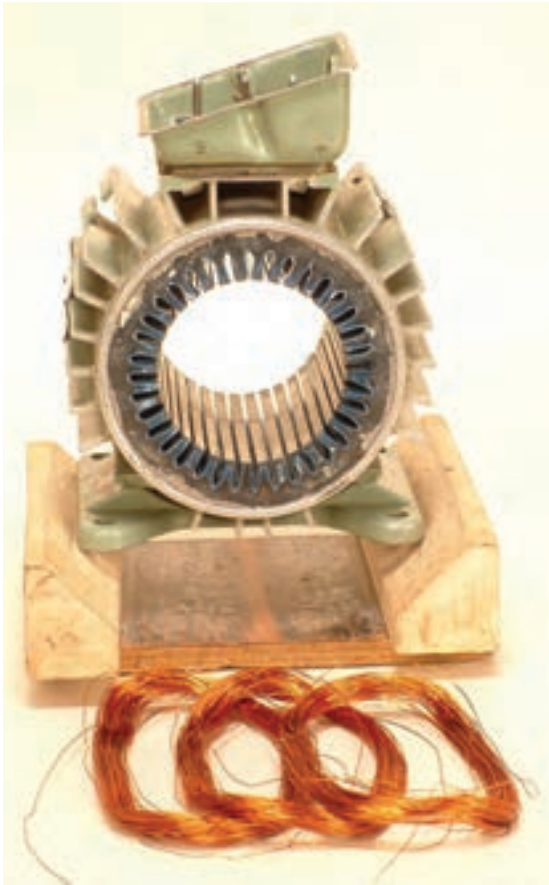
شکل ۲-۱۴- تعیین محل قرار گرفتن کلاف ها
