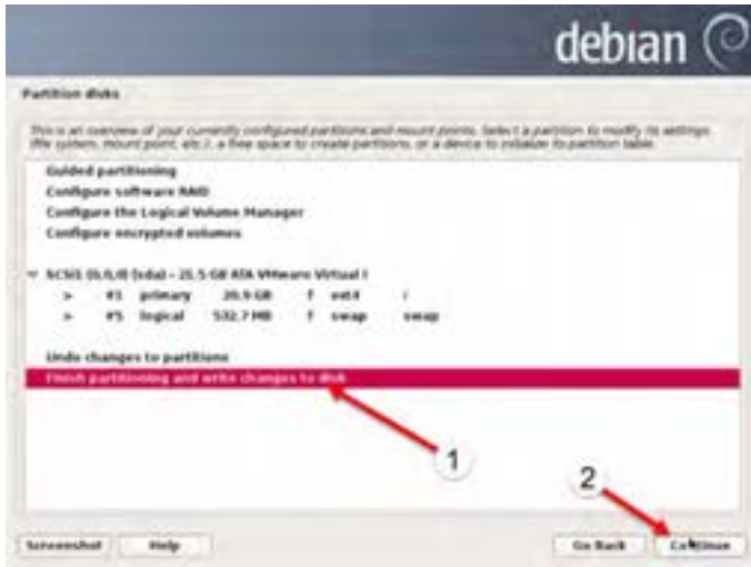
شکل ۵۱- ۹- نصب پارتیشن بندی دیسک سخت
