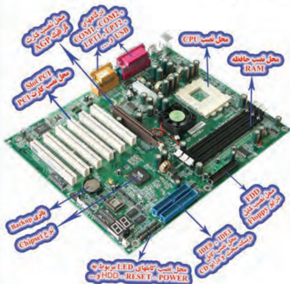
شکل (۵-۱) برد اصلی (Mainboard)
