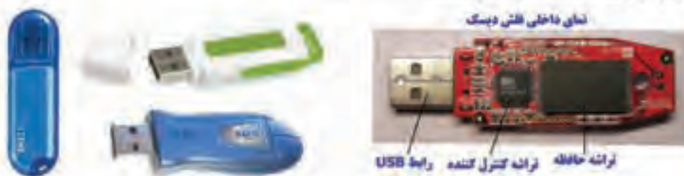
شکل (۱۶-۴) نمونه های از Flash Disk و نمای داخلی آن
