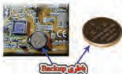
شکل (۱۸-۵) باتری Backup
