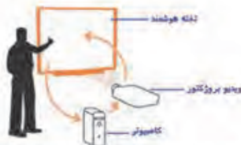
شکل (۳-۲۵) ویدیو پروژکتور تصویر صفحه نمایش رایانه را بر روی تخته هوشمند نمایش می‌دهد و تخته هوشمند خطوطی را که استاد با قلم مجازی ترسیم می‌کند، بر روی تخته نمایش نازده و بر روی رایانه نیز ذخیره می‌تواند.
