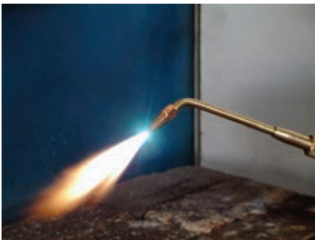
شکل ۲-۳- شعله‌ی سوختن گاز استیلن با اکسیژن
