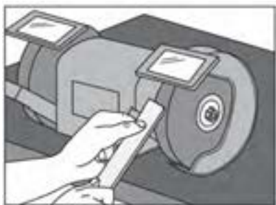
شکل ۱۴-۴۵ قرار دادن تیغه روی تکیه‌گاه.
