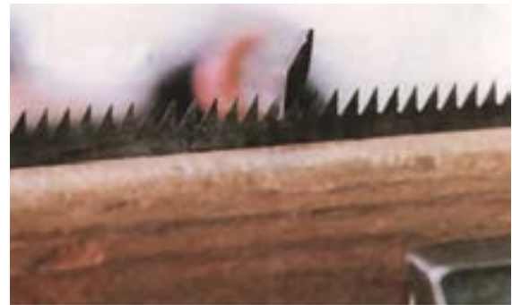
شکل ۱۴-۵۸- تیزکردن اره با سوهان دم‌کاردی با مقطع لوزی.
