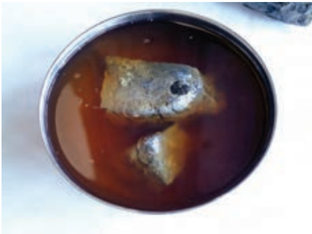
شکل ۱۲-۲ نگهداری کاربید در زیر نفت
