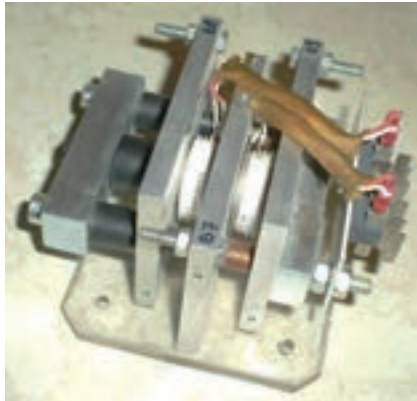
شکل ۳-۳- تریستورهای دیسکی همراه با گرماگیر
