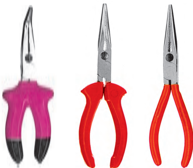
الف - دم باریک دسته عایق معمولی نوک گرد ب - دم باریک دسته عایق فشار قوی با نوک بلند ج - دم باریک دسته عایق فشار قوی با نوک کج ۴۵°
