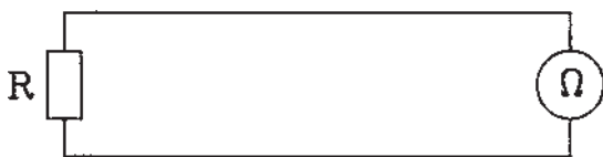
شکل ۵-۵۴- مدار اتصال اهم متر به مقاومت
