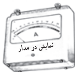
شکل ۲۹-۵ شکل ظاهری آمپر متر
