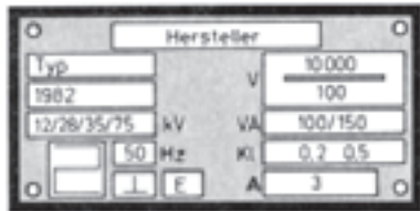
شکل ۵-۶۹- پلاک مشخصات ترانسفورماتور ولتاژ
