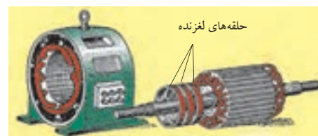
شکل ۱-۴۶- اجزای موتور روتور سیم پیچی
