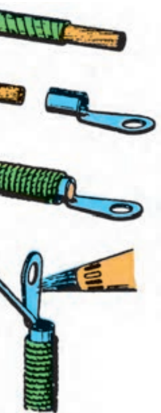
شکل ۲۸-۵- مراحل لحیم کاری کابل شو
