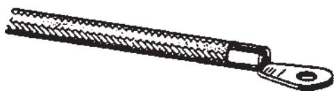
شکل ۲۹-۲- مراحل اتصال کابل شو به سیم توسط لحیم کاری
