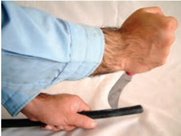
شکل ۳۳-۵- طریقه‌ی صحیح روکش برداری کابل
