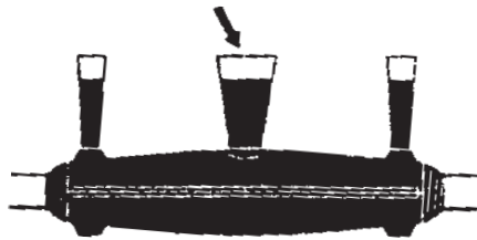
شکل ۶-۲۴- ماده‌ی رزین تا \frac{1}{4} ارتفاع قیف ریخته می‌شود.
