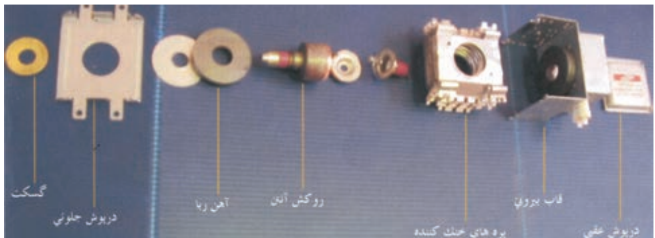
شکل ۳-۹۶ نقشه‌ی انفجاری قطعات یک مگنترون
