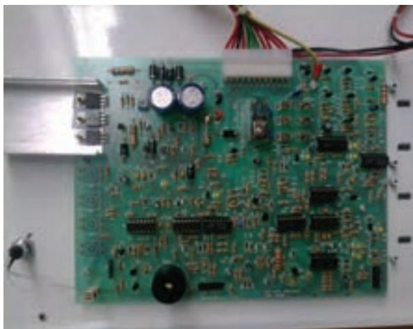
شکل ۱-۲۹ مدار الکترونیکی یک نمونه تابلو اعلام حریق
