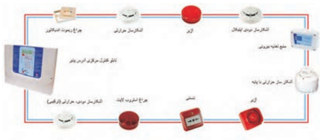
شکل ۱-۲ سیستم اعلام حریق آدرس پذیر
