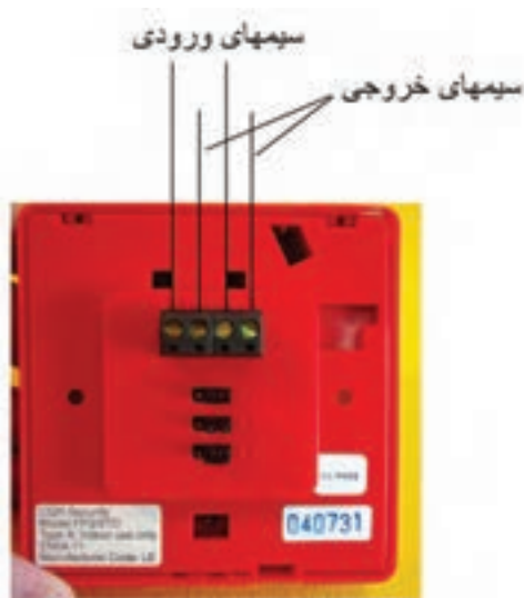
شکل ۳۹-۱ سیم های اتصال شستی
