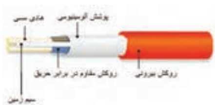
شکل ۲۴-۱ قسمت‌های مختلف یک کابل اعلام حریق
