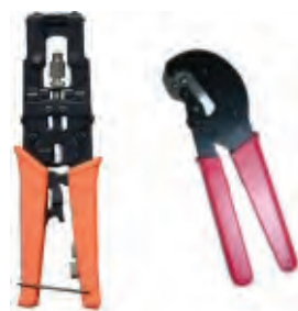
شکل ۳-۳۶ دستگاه پرس BNC
