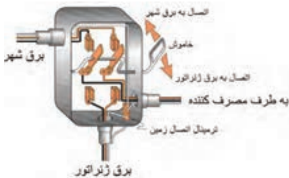
شکل ۱۷-۵ کلید تعویض دو طرفه تک فاز
