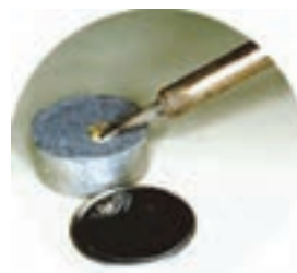
د- تمیز کردن سر هویه
