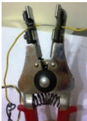
شکل (۱-۴) برداشتن روکش سیم‌ها
