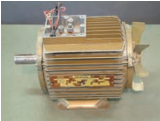
شکل ۱۹-۱- الکتروموتور سه فاز
