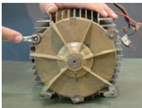
شکل ۱-۲۴- پیچ و مهره‌های باز شده از موتور
