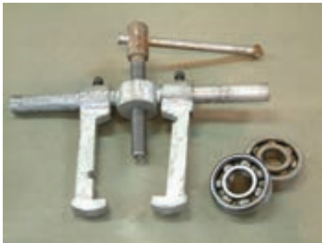
شکل ۱-۴۷- بلبرینگ‌ها پس از جدا شدن از محور
