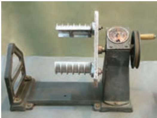
شکل ۱۵-۳- تنظیم اندازه‌ی قالب‌ها در کلاف پیچ
