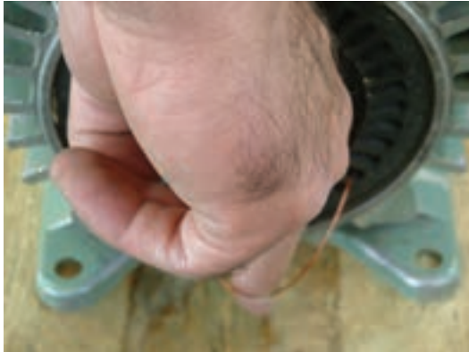
شکل ۱۴-۳- تعیین اندازه‌ی کلاف‌ها با توجه به گام کلاف
