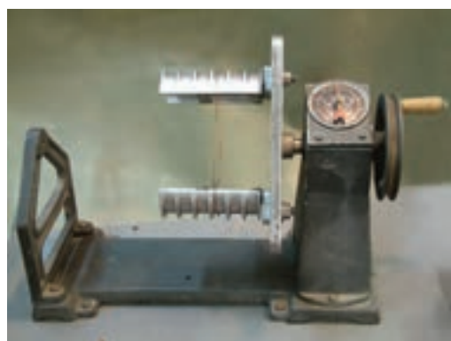
شکل ۳-۵- تنظیم قالب‌ها بر اساس اندازه‌ی کلاف
