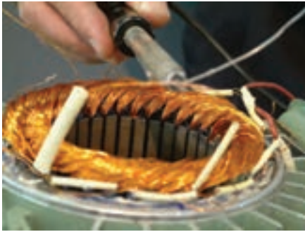
شکل ۴-۷- لحیم کاری محل اتصال سیم ها
