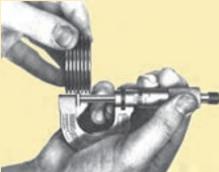
شکل (۲-۴) نحوه در دست گرفتن میکرومتر
