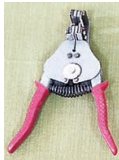
شکل (۱-۲۹) سیم لخت کن اتوماتیک
