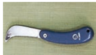
شکل (۱-۳۰) چاقوی مخصوص روپوش برداری کابل
