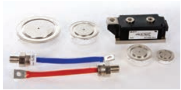
شکل ۱۰-۱ چند نمونه دیودهای بازیافت سریع
