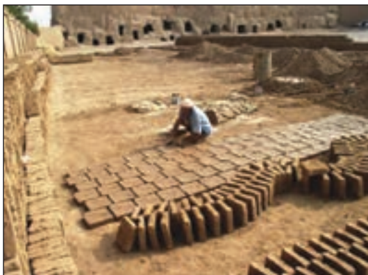
شکل ۵۴-۱ خشت خام (ساخت آجر به روش دستی)
