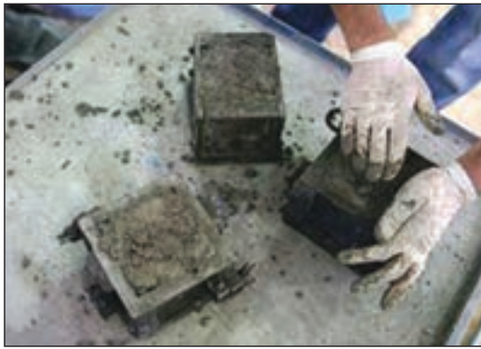
شکل ۵۱-۱ آزمایش مقاومت بتن
