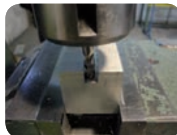
شیار تراشی با تیغه فرز انگشتی
