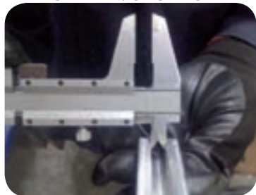
اندازه گیری پهنای شیارها با کولیس ورنیه دار
