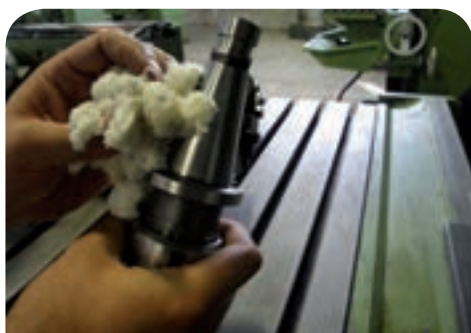
تمیز کردن دنباله میله فرزگیر
