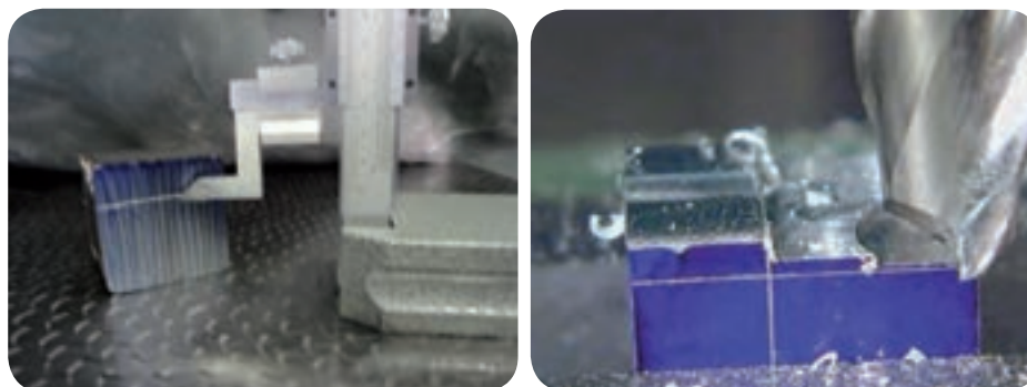
خط کشی قطعه کار جهت کنترل بهتر در هنگام براده برداری
