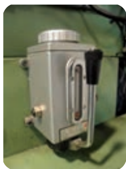
دو نمونه نمایش گر سطح روغن دستگاه
