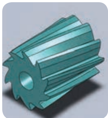
تیغه فرز دارای لبه‌های برنده مارپیچ
