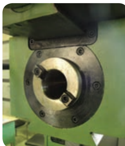
تمیز کردن گلویی قبل از بستن میله فرز گیر
