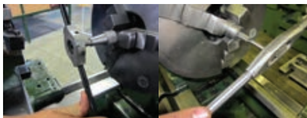
۴- تنظيم کردن نوک لبه رنده در مرکز کار
