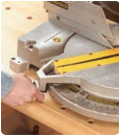
شکل ۸-۲ تنظیم زوایای مختلف برش
