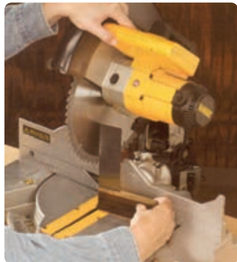
شکل ۷-۲ تنظیم عمود بودن تیغه پشت به صفحه
