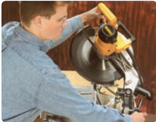
شکل ۹-۲ تنظیم زاویه چرخش اره گرد
