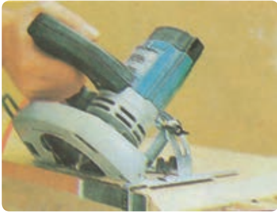
شکل ۳۷-۲ برش تحت زاویه به وسیله گونیای دستگاه
