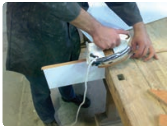
شکل ۱۴۷-۲ اتوکشی نوار روکش لبه چسبان
