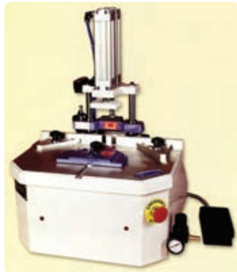
شکل ۱۰۶-۲ ماشین دم چلچلهزن نیوماتیکی
