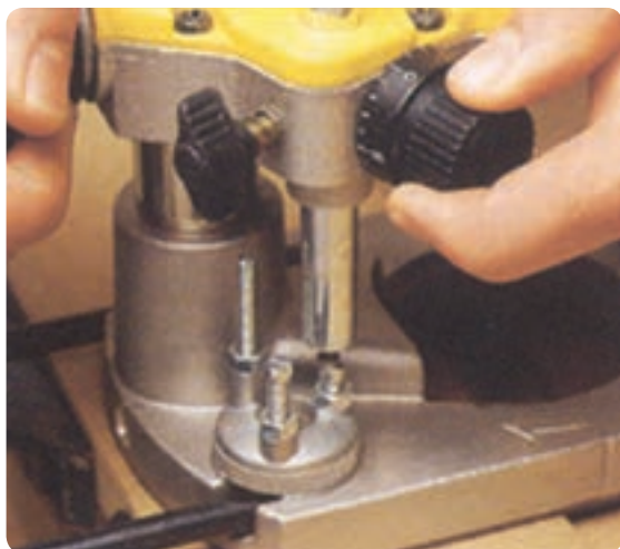
شکل ۷۲-۲ پیچ‌های تنظیم دستگاه
