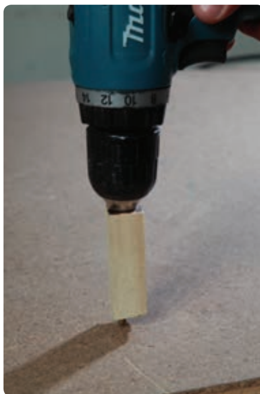
شکل ۳۲-۳ سوراخ دریل قطعه کنترل اندازه عمق
