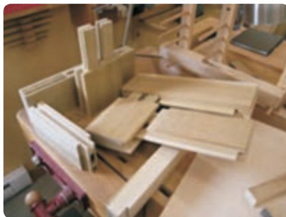
شکل ۴-۱ اتصالات مختلف در صنایع چوب
