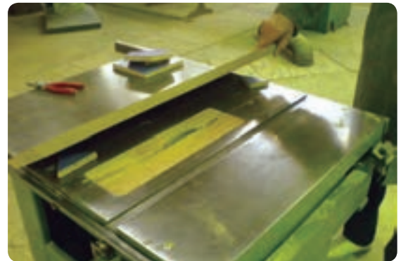
شکل ۳-۳۹ قراردادن دو عدد زیرسری برای ساخت گونیا
