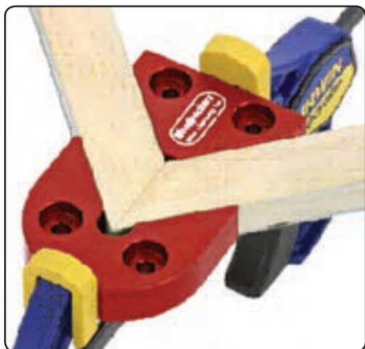
شکل ۳۳-۳ فیکسچر جهت مونتاز قاب به حالت افقی
