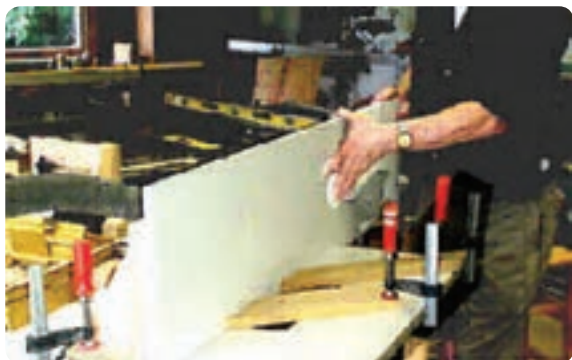
شکل ۳-۲۷ شانه‌های حفاظتی به صورت افقی
