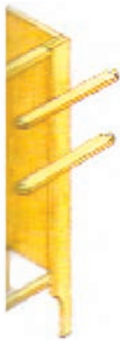
شکل ۶۳-۸ موقعیت قیدهای عرضی داخلی در کابینت پایه‌دار
