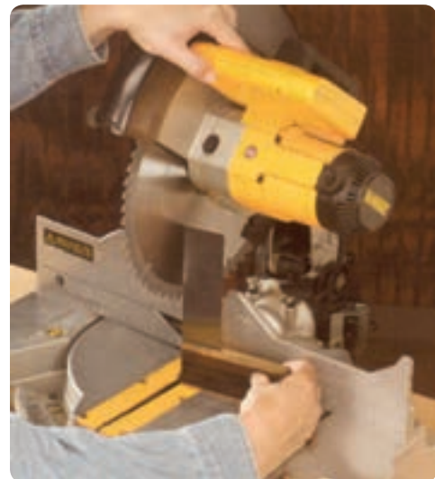
شکل ۷-۲ تنظیم عمود بودن تیغه پشت به صفحه
