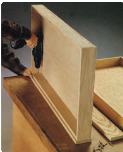
شکل ۴۰- کاربرد تخته سه‌لایه در کف جعبه
