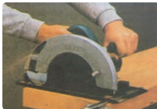
شکل ۳۶-۲ برش به وسیله گونیای دستگاه
