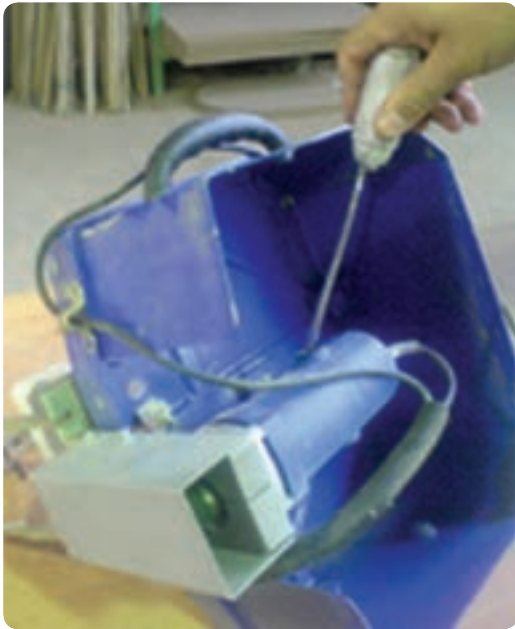
شکل ۱۱۷-۲ تصویر از زیر دستگاه گرفته شده است که در پوش بیچی زغال کلکتور جهت بازدید باز می‌شود
