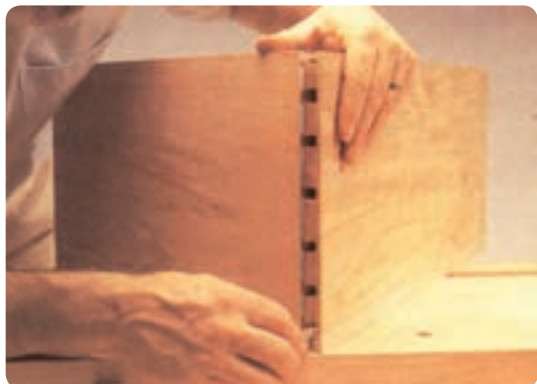
شکل ۶-۱۴۰ مونتاژ آزمایشی قبل از چسب زدن قطعات
