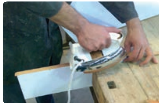
شکل ۶-۸۱ لبه چسبانی روکش مصنوعی با اتو
