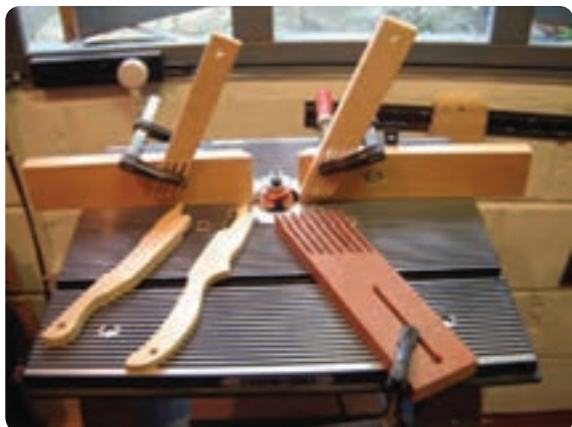
شکل ۳-۲۸ شانه‌های حفاظتی به صورت عمودی
