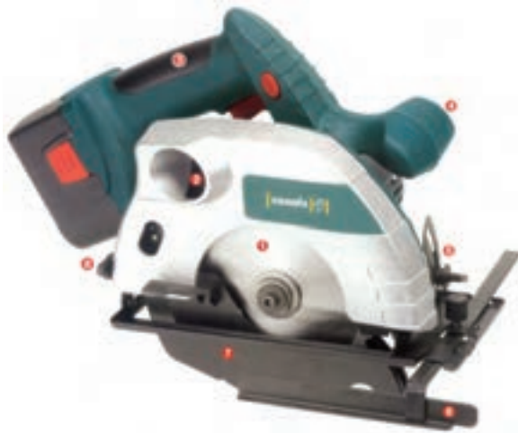
شکل ۲۱-۲ تنظیمات ماشین اره گرد دستی برقی
