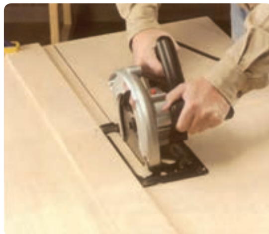
شکل ۲-۲۳ برش طولی با گونیای برراستی
