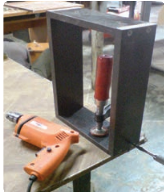
شکل ۶-۱۰۸ مونتاژ دستی جعبه کشو
