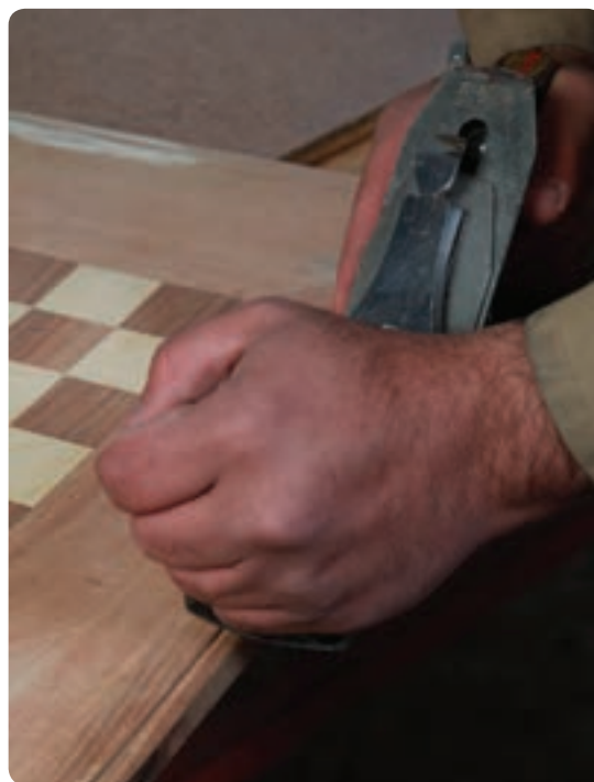
شکل ۶-۷۹ رنده کردن زهوار چوبی
