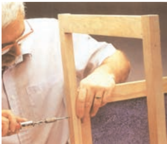
شکل ۶-۱۶۰ مونتاژ قاب پشت با قاب کناری
