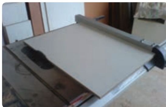
شکل ۶-۶۷- برش صفحات با اره مجموعه‌ای
