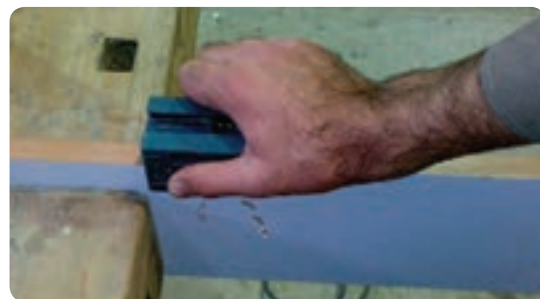
شکل ۶-۸۲ پرداخت لبه اضافی روکش
