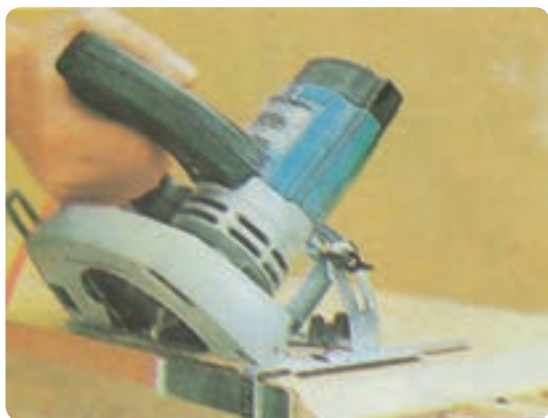
شکل ۳۷-۲ برش تحت زاویه به وسیله گونیای دستگاه
