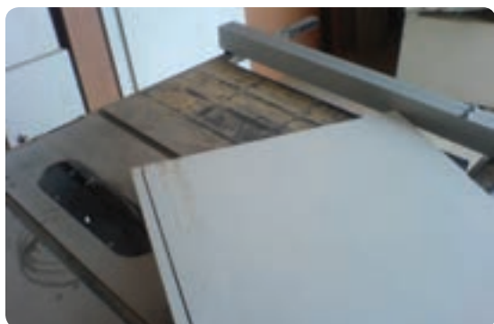
شکل ۶-۶۹- کنشکاف زدن جهت پشت بند
