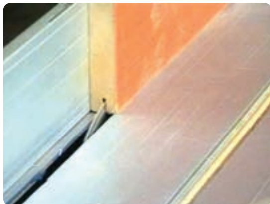
شکل ۶-۹۰ دو راهه کردن با ماشین اره مجموعه‌ای
