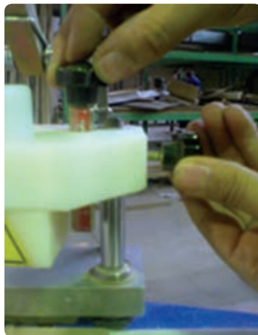
شکل ۲-۱۱۳ تنظیم عمق فرز جهت اتصال
