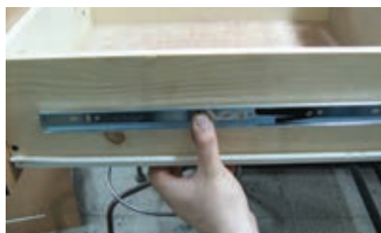
شکل ۷-۳۵ تعیین محل ریل بر روی بدنه کشو
