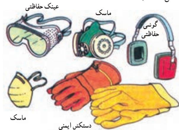
شکل ۳۸-۲ استفاده از وسایل حفاظتی
