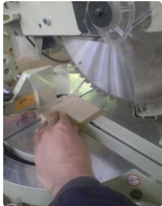
شکل ۱۶-۲- عدم رعایت نکات ایمنی برای برش قطعات کوچک تر
