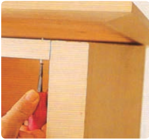
شکل ۶۹- ۸ بستن صفحه روی کابینت
