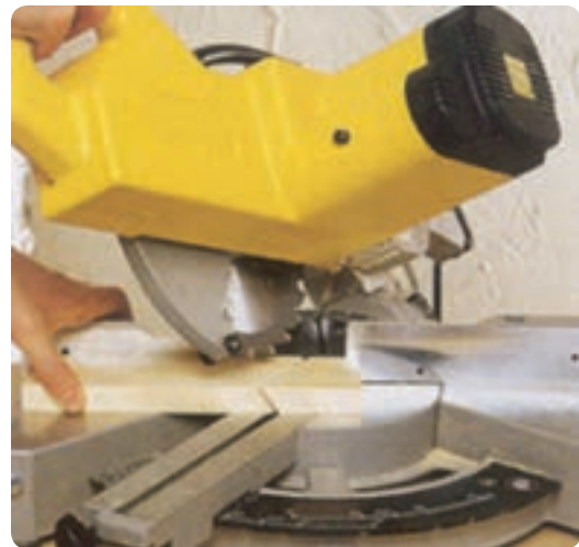
شکل ۱۴-۲- برش تحت زاویه
