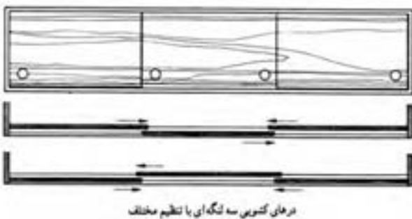
شکل ۶-۲۷ درهای کشویی سه لنگه‌ای با تنظیم مختلف
