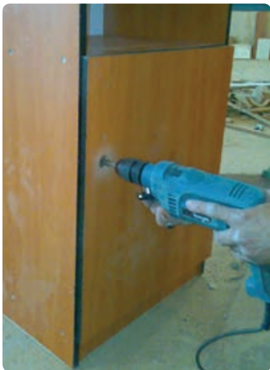
شکل ۱۲۳-۶ در آوردن جای قفل سوئیچی
