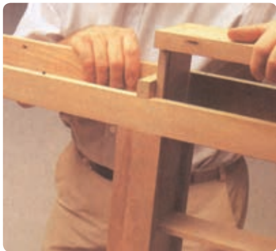
شکل ۶-۱۵۷ اطمینان از گونیی قاب
