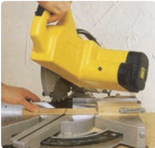
شکل ۲-۱۲- برش قائم با اره گرد فارسی بر
