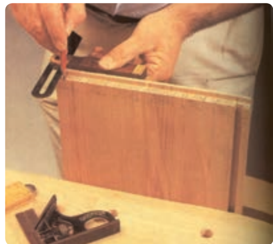
شکل ۶-۱۳۶ خط‌کشی اتصال دم‌چلچله دورو مخفی
