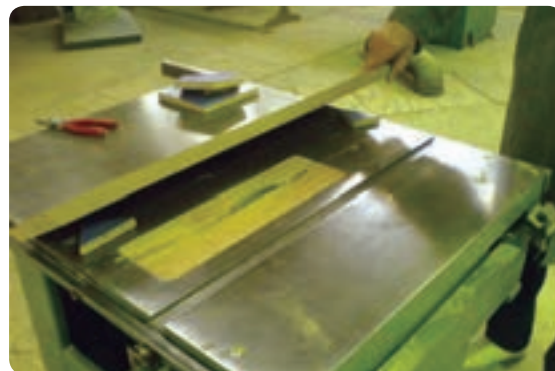
شکل ۳-۳۹ قراردادن دوعدد زیرسری برای ساخت گونیا
