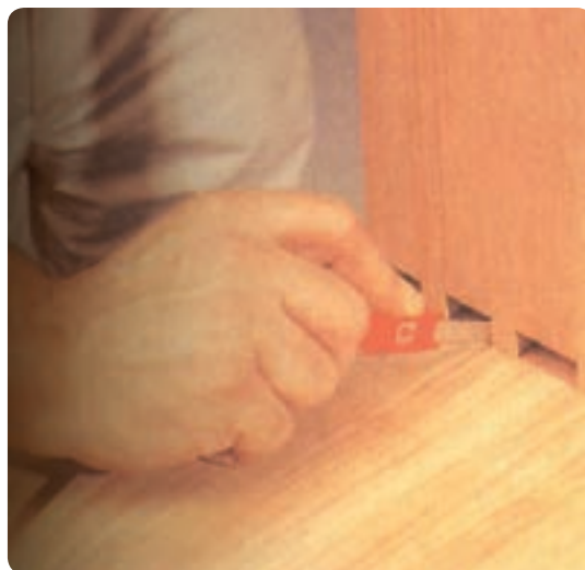
شکل ۶-۱۳۸ خط‌کشی جای فاق روی قطعه دیگر
