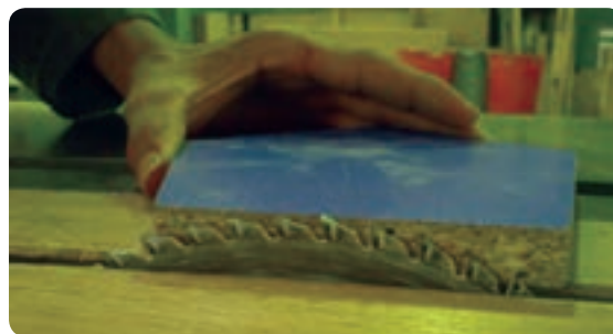
شکل ۳-۳۸ تنظیم ارتفاع تیغه اره
