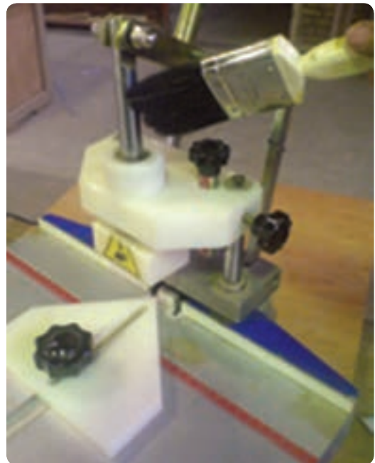
شکل ۱۱۶-۲ تمیز کردن مفصل‌های حرکتی ماشین دم چلچله‌زن
