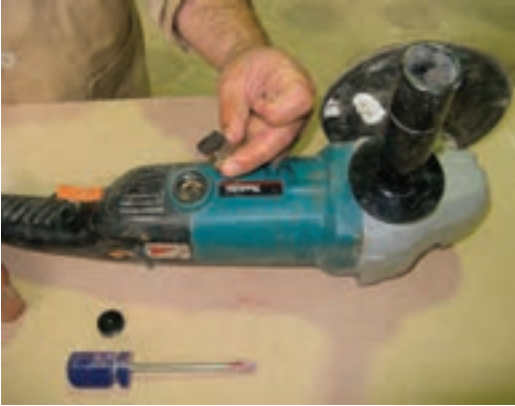
شکل ۳۵-۵- بازدید ذغال دستگاه سنباده دیسکی.
