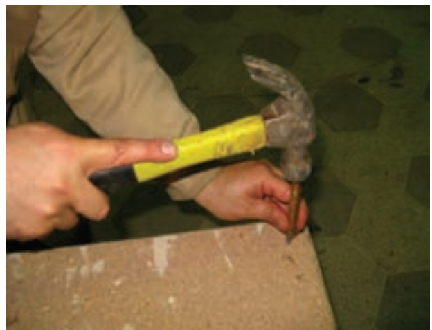
شکل ۱۷-۱۱- سنبه‌کردن میخ در یک کار پوششی.
