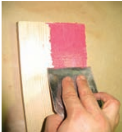
شکل ۴۶-۶- ماستیک کاری سطح کار با بتونه (روغنی قرمز رنگ).
