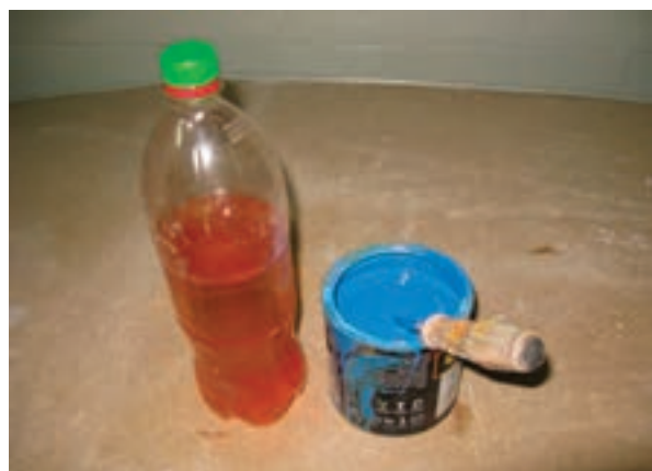
شکل ۵۲-۱۳- استفاده از بنزین در رنگ روغنی برای سریع خشک شدن رنگ.
