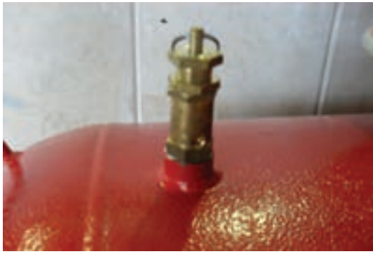
شکل ۱۰-۷- سوپاپ کمپرسور برای فروغ هوای اضافی.
