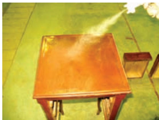
شکل ۵-۱۲- پاشیدن رنگ نیتروسلولوزی با پیستوله.
