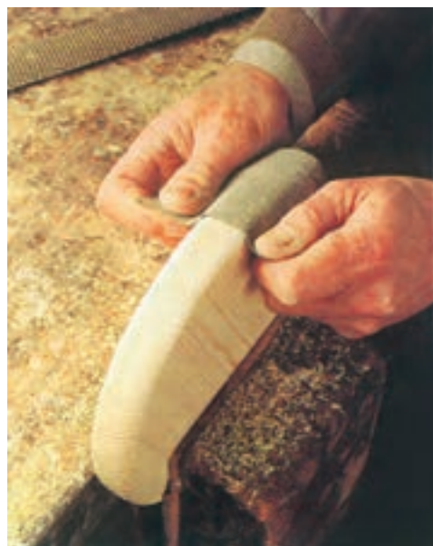
شکل ۲۶-۴ - سنبله‌کاری (روی سطوح قوس‌دار).
