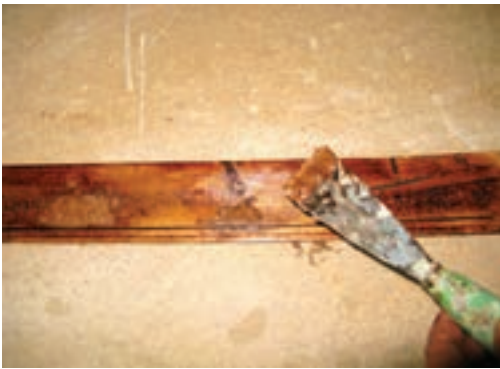
شکل ۱۳-۶- یک تخته آستری فورده، بتونه بایستی مطابق با سطح آستر فورده سافته شود.
