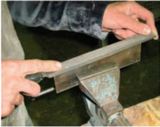
شکل ۱۰-۳- سوهان کشیدن روی نر لیسه.
