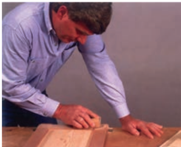
شکل ۳۸-۱۲- زدن آستری گردویی به سطح کار.
