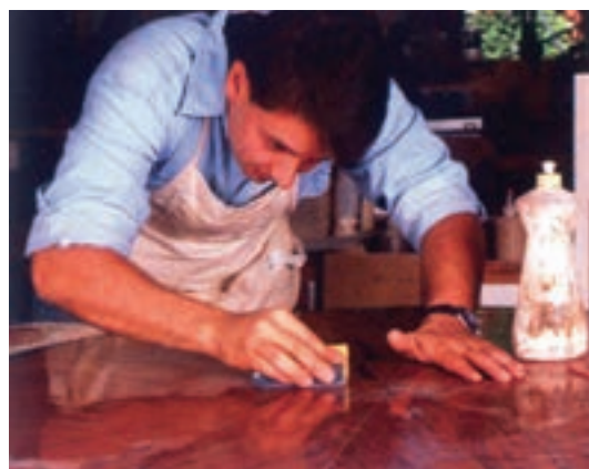
شکل ۱۲-۲۳- سنباده‌کاری سطح پلی استر فورده.
