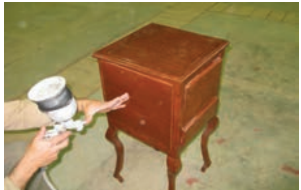
شکل ۴۰-۸- فاصله‌ی انگشت کوچک و شصت بین ۱۵ تا ۲۵ سانتی‌متر می‌باشد.
