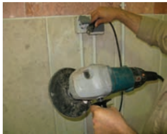
شکل ۲۰-۱۳- کشیدن دوشافه ماشین پوست گرد از پریز.
