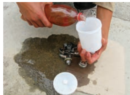
شکل ۷-۹- هنگام شستشوی پیستوله رنگ‌کاری کاملاً قطعات آنرا باز نموده و تمیز کنید.
