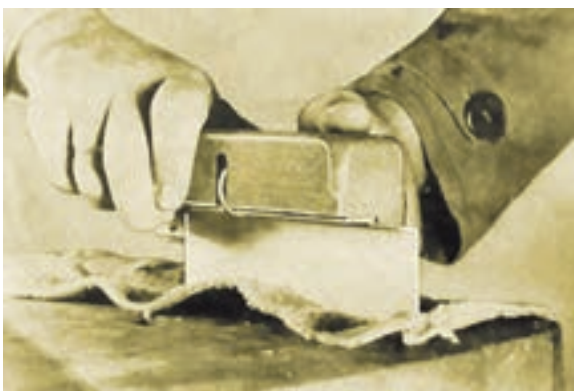
شکل ۳-۴۵- مصقل‌کشی لیس با رنده مصقل.
