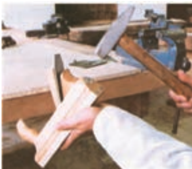
شکل ۳-۵۵- پر تیغ و کم تیغ کردن رنده چوبی.
