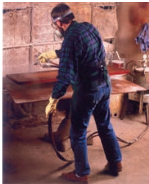
شکل ۱۲-۲۲- پاشیدن پلی استر ایستاده به سطح کار.
