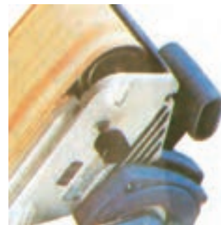
شکل ۲۰-۵- با این پیچ می‌توان غلطک جلو را حرکت داد.
