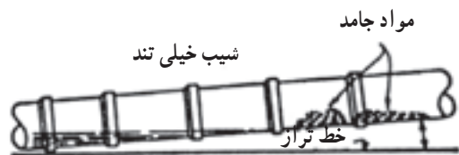
شکل ۱۱-۳ الف - نتیجه‌ی شیب زیاد لوله‌ی افقی فاضلاب
